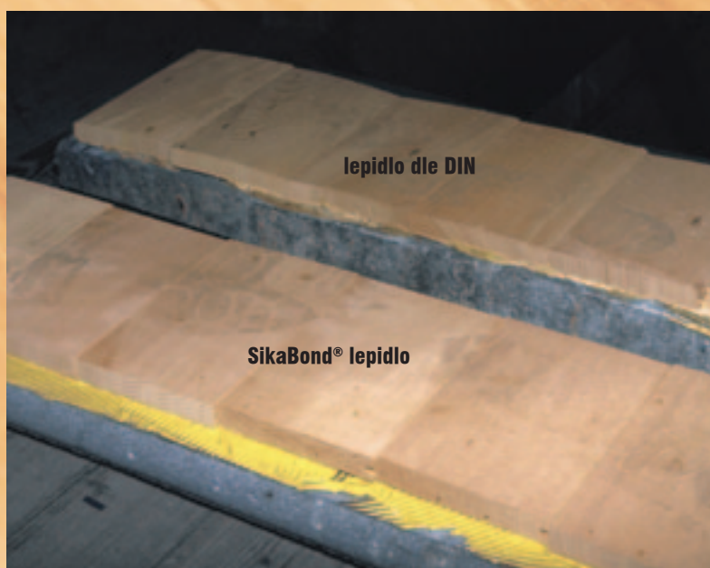
obr. 5: test při extrémních podmínkách: 20 mm silné masivní bukové prkno, zbytková vlhkost dřeva 22%
