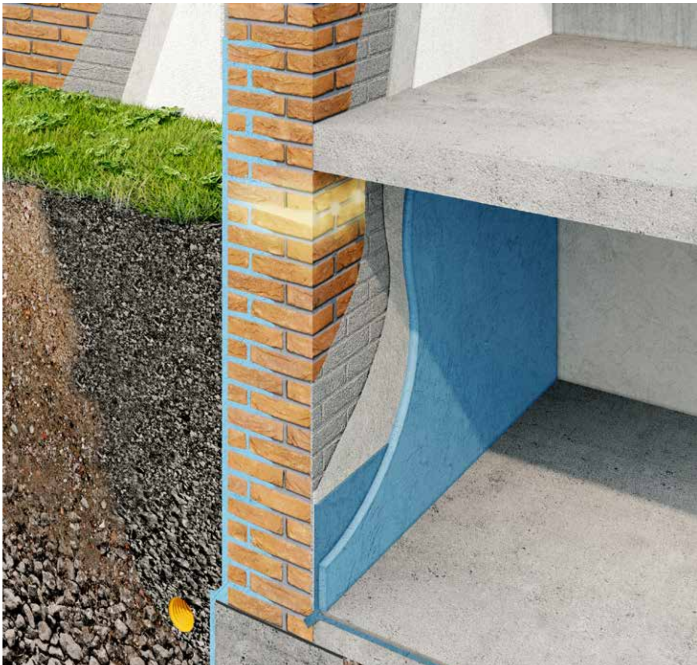
Technický detail hydroizolace suterénní stěny s chemickou injektáží a sanačními omítkami - viz. str 48
